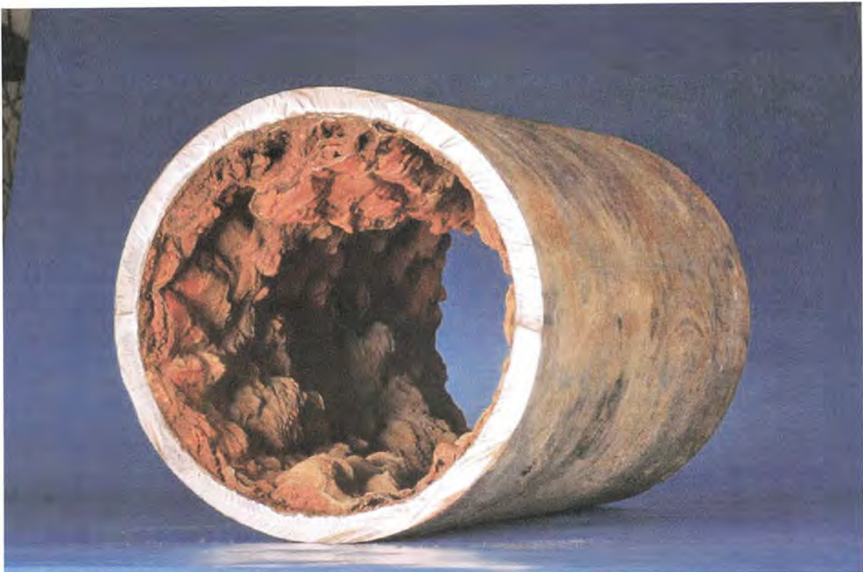
Bilde av en støpejernsledning da 50 år
